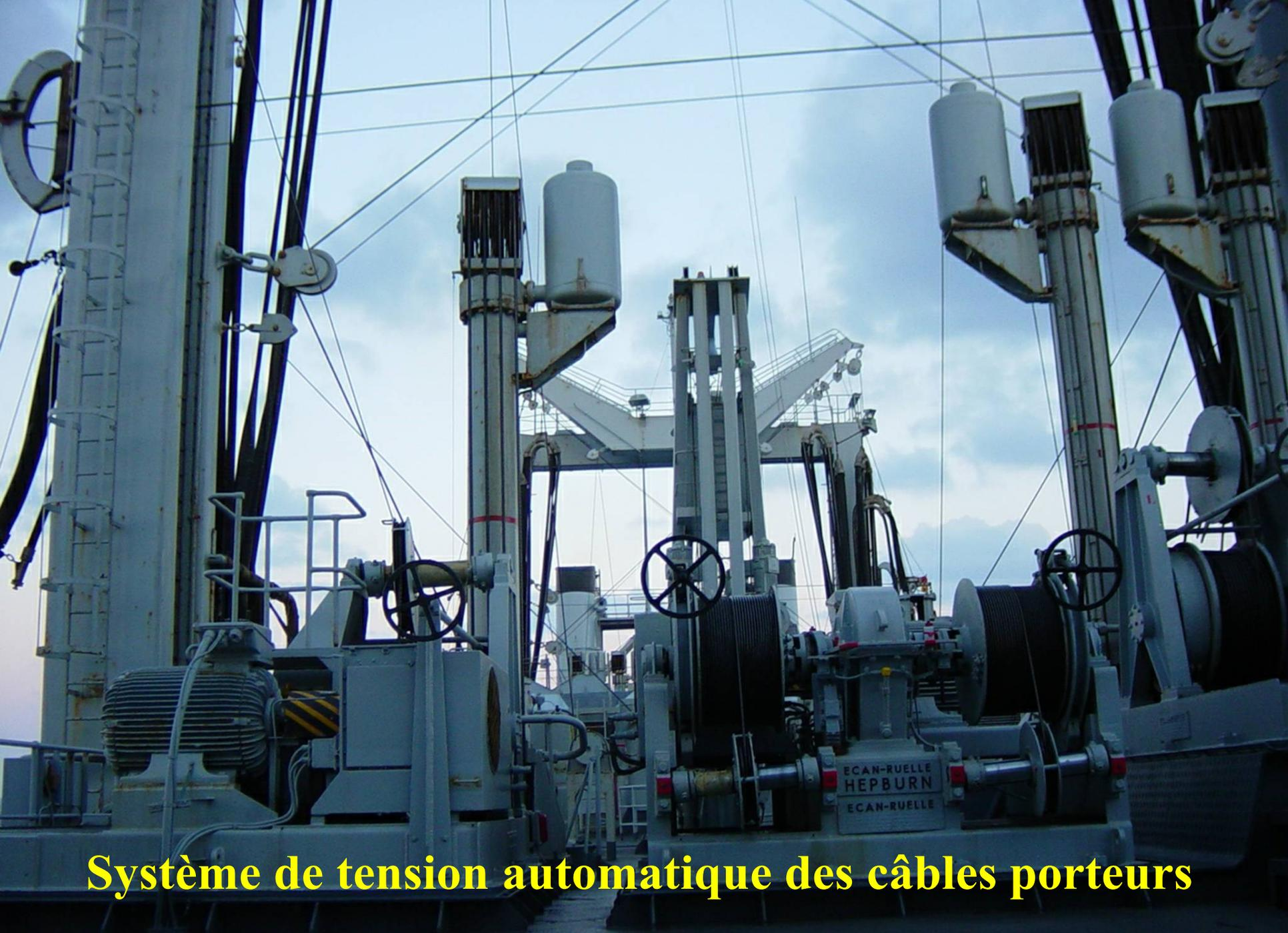
**Systeme de tension automatique des cables porteurs**
